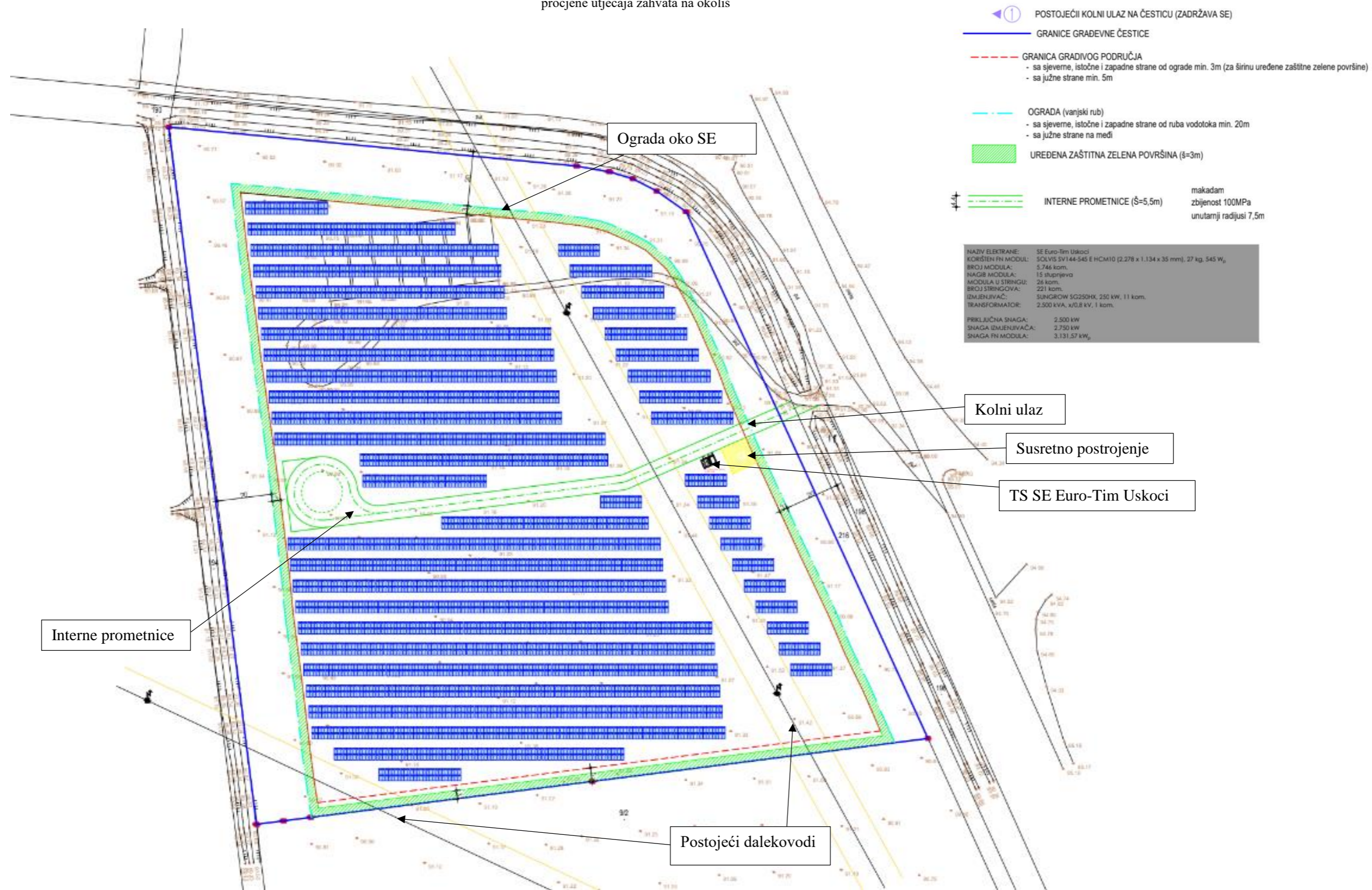
Slika 4. SE - Situacija i dispozicija FN modula (Izvor: Solvis d.o.o., Varaždin, kolovoz 2023.)
